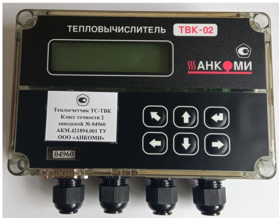
Рисунок 2 – Места нанесения заводского номера и знака утверждения типа
